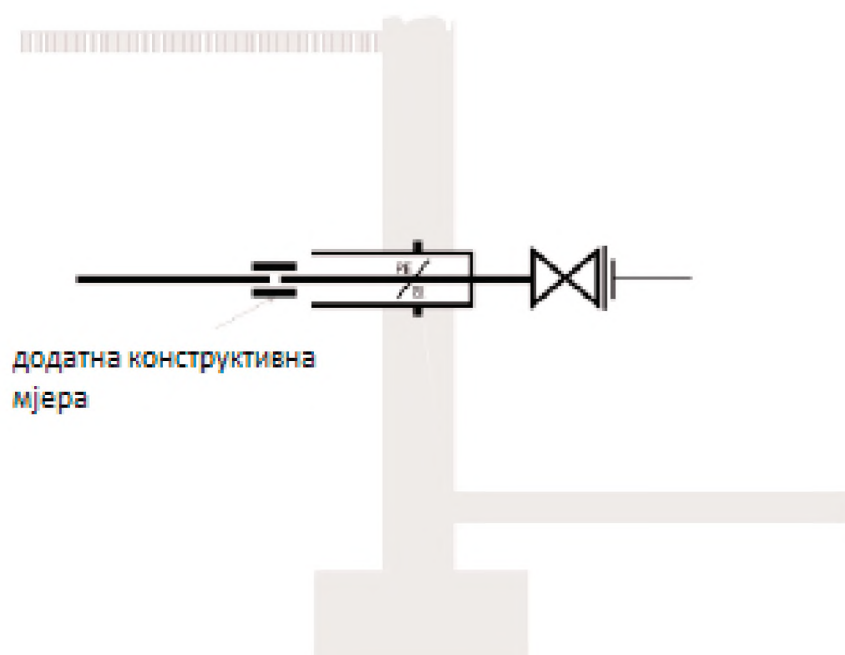
Слика 6. Кућни прикључни вод од РЕ ( d_a > 63 \text{ mm} ), увођење у кућу са цијевном капсулом према VP 601 (чврста тачка у комбинацији са додатним конструктивним мјерама)
