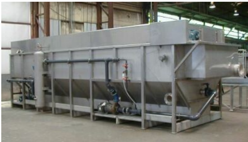
Slika 24 Primjer uređaja za DAF-flotaciju
