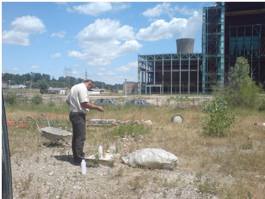
Slika 37 Uzorkovanje podzemne vode na BH-13
