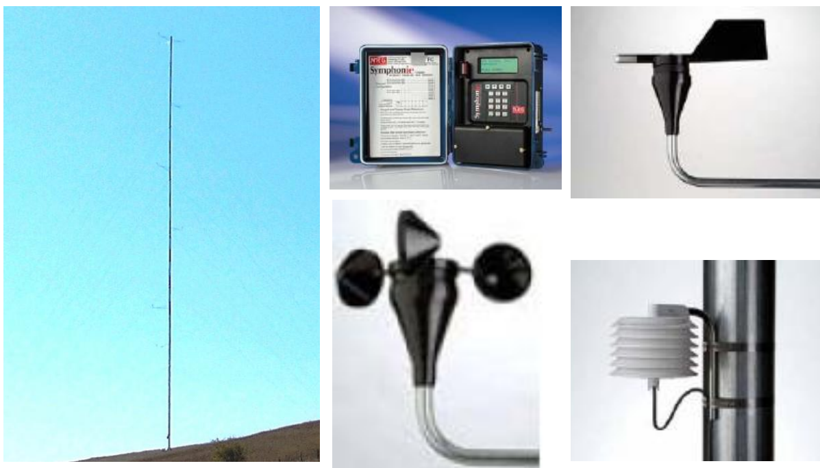
Slika 45. Mjerni stub sa sensorima za mjerenje vjetra
