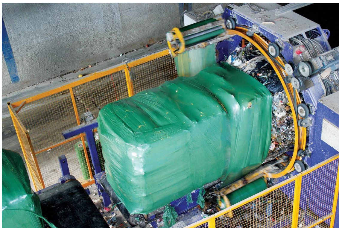
Slika 5. Motanje RDF-a streč folijom radi zaštite, transporta i skladištenja
