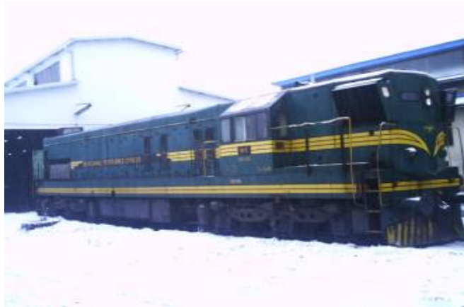
Sl. br. 29-Dizel električna lokomotiva serije 661
