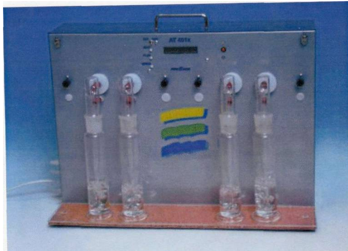
Sl.br.98. Uređaj za mjerenje kvaliteta vazduha AT 401-H
