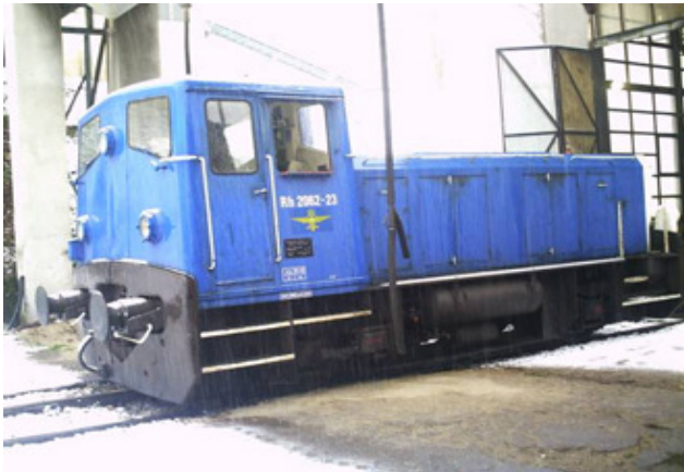
Sl. br.31-Dizel hidraulična lokomotiva serije R h 2062
